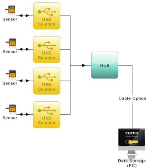
Le applicazioni che prevedono una moltitudine di sensori sono facilmente gestite ed integrabili con la soluzione SENSIT con un normale hub USB. Allo stato la configurazione standard implementa fino ad un massimo di sedici sensori.
