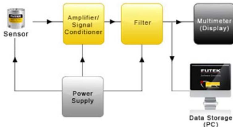
Una catena di misura tipo deve includere: un amplificatore/condizionatore di segnale con un filtro analogico attivo, un alimentatore DC esterno, un multimetro per la lettura oppure una scheda o modulo di acquisizione dati connesso a un pc.
